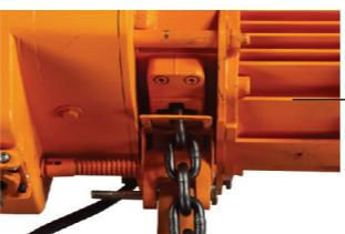
Концевой выключатель в новом дизайне встроен в корпус, меньше изнашивается, не требует регулировки, позволяет работать «с оттяжкой», то есть с угловым отклонением.
