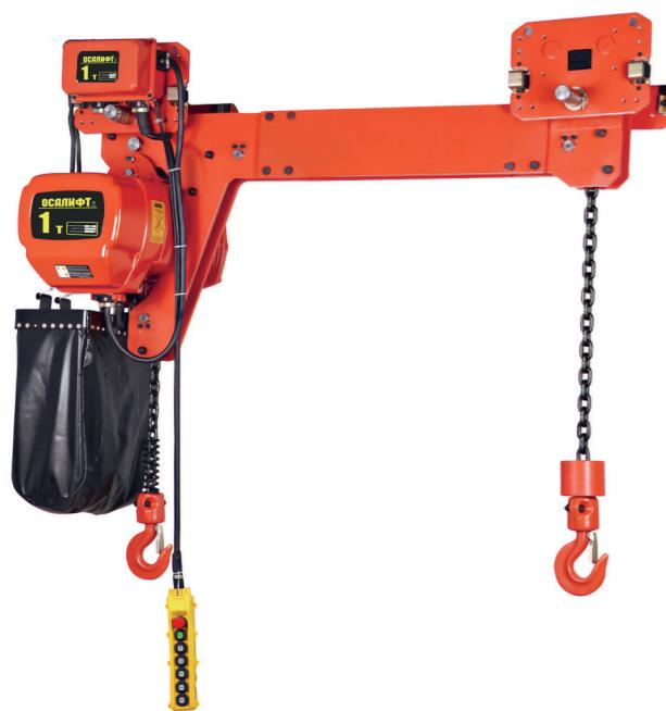
Электрическая цепная таль с двумя крюками на электрической передвижной тележке. Данная модель позволяет поднимать без помощи траверс габаритные изделия, барабаны, рулоны и тд.
