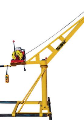
Строительная лебедка TSA со свободным спуском предназначена для массового применения в строительстве, отделочных и фасадных работах, а также для любых подъемно-тяговых действий. На лебедку установлена муфта сцепления. Муфта позволяет отсоединить барабан с канатом от редуктора двигателя. Эта функция позволяет быстро спустить крюк вниз, не включая лебедку, что ускоряет работу и сохраняет ресурс лебедки. Муфта приводится в действие вручную с помощью рычага на барабане лебедки.
